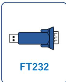
FTDI UARTやFT-XデバイスなどシリアルからUART変換したUSBデバイスの接続をサポートします。
