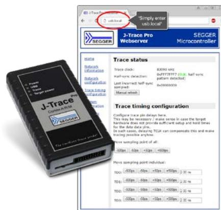
操作のLCDディスプレイを搭載できないサイズの製品である「SEGGER J-Trace PRO」に接続された Web ブラウザのスクリーンショットで、現在何が起きているかを表示しています。表示されているページでは、トレースピン遅延の設定が可能です。
