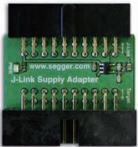
「J-Link Supply Adapter」を利用する事で、VT Ref の固定 I/O 電圧レベルを提供します。これにより VT Ref (pin1) をターゲットに接続する必要がなくなります。
